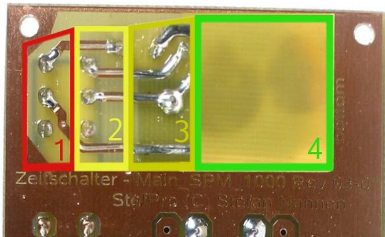
Figure - Abbildung 6: After reinforce the conductor tracks - Nach verstärken der Leiterbahnen
