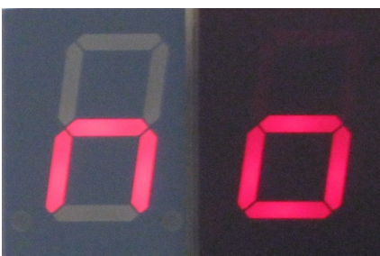
Abbildung 7: SA08-11SRWA links ohne und rechts mit Kontrastscheibe ohne Gegenlicht
