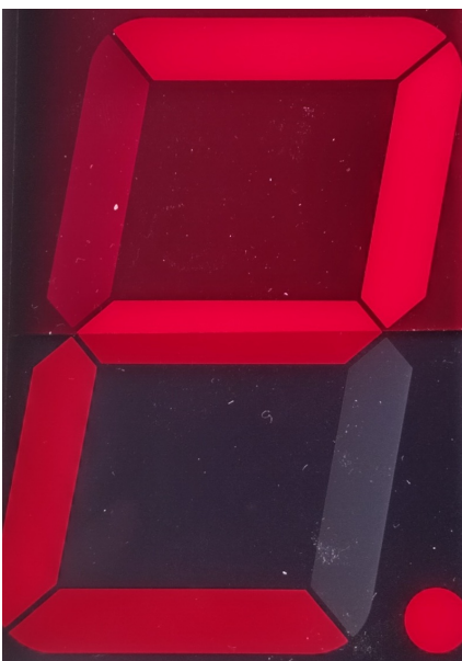
Abbildung 9: SA40-19SRWA oben rote und unten graue Kontrastscheibe mit Gegenlicht
