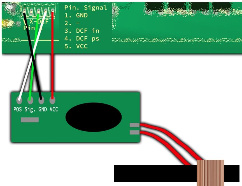
Abbildung 4: DCF Verbindung mit VCC und PowerSave
