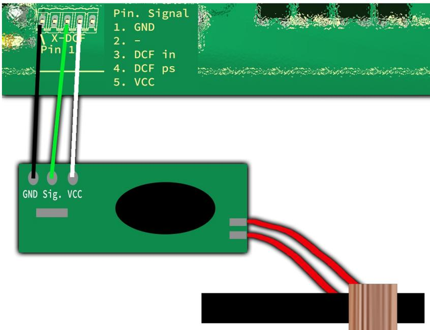
Abbildung 3: DCF Verbindung mit PowerSave
