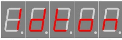
(Kanalnummer) Temperaturanzeige an
