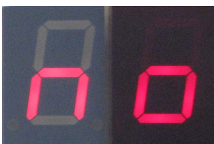
Abbildung 5: SA08-11SRWA links ohne und rechts mit Kontrastscheibe ohne Gegenlicht
