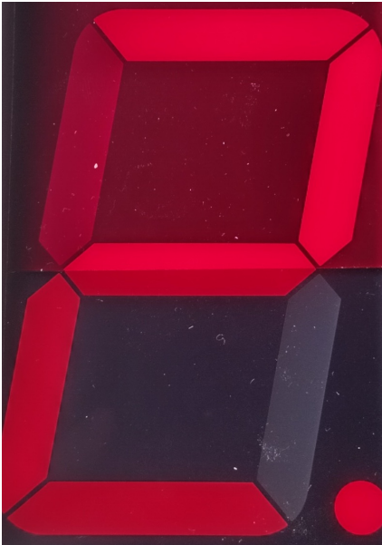
Abbildung 8: SA40-19SRWA oben rote und unten graue Kontrastscheibe mit Gegenlicht
