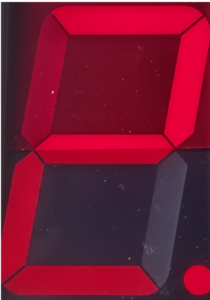
Abbildung 7: SA40-19SRWA oben rote und unten graue Kontrastscheibe mit Gegenlicht
