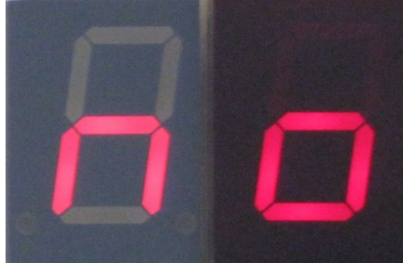
Figure - Abbildung 10: SA08-11SRWA left without and right with contrast pane without back light. - SA08-11SRWA links ohne und rechts mit Kontrastscheibe ohne Gegenlicht
