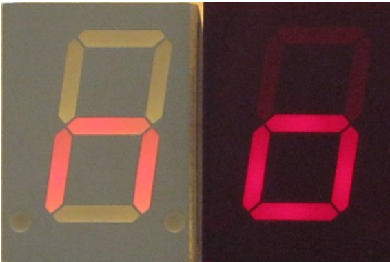
Figure - Abbildung 9: SA08-11SRWA left without and right with contrast pane with back light. - SA08-11SRWA links ohne und rechts mit Kontrastscheibe bei Gegenlicht
