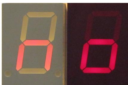
Abbildung 7: SA08-11SRWA links ohne und rechts mit Kontrastscheibe bei Gegenlicht
