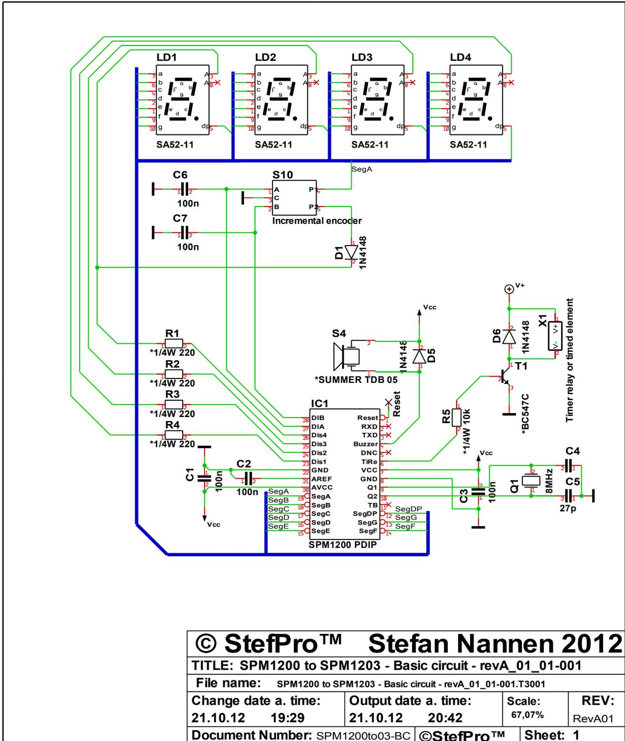
Figure - Abbildung 4 Basic circuit - Grundschtaltung des SPM1200 - SPM1202
