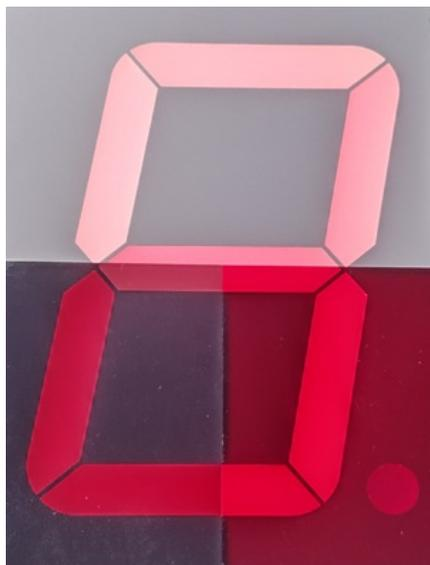
Abbildung 20: SA40-19SRWA oben ohne, unten links graue und rechts mit rote Kontrastscheibe mit Gegenlicht
