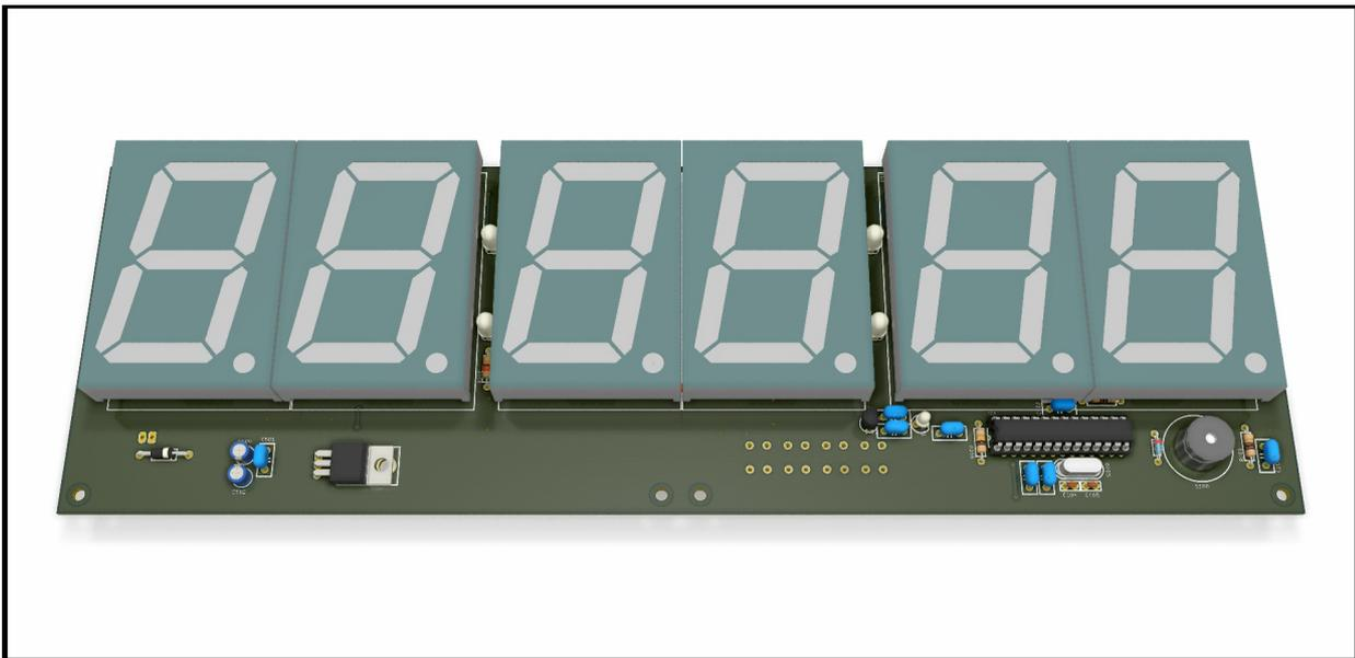
Abbildung 16: Komplette Bestückung vom SPK2241.01 mit Anzeigen
