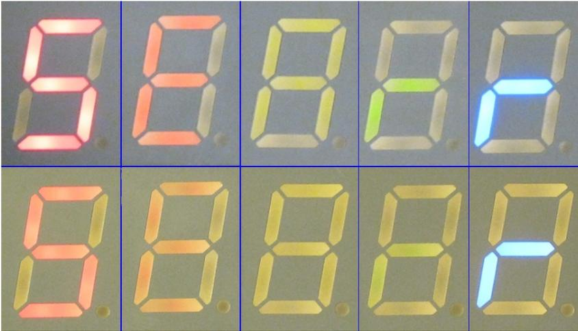
Abbildung 14: Unterschiede der Display Lesbarkeit Helligkeitsstufe 25
