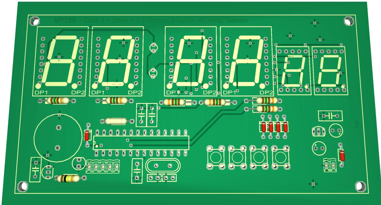
Abbildung 5: Bestückung vom SPK2201.01 Schritt 1
