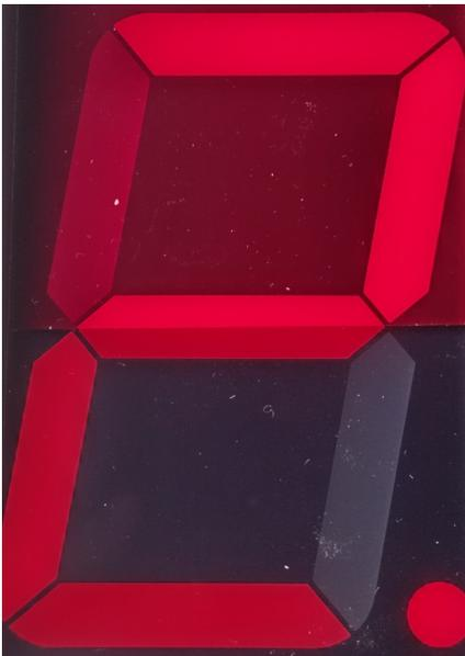
Abbildung 18: SA40-19SRWA oben rote und unten graue Kontrastscheibe mit Gegenlicht
