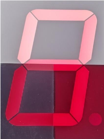
Abbildung 17: SA40-19SRWA oben ohne, unten links graue und rechts mit rote Kontrastscheibe mit Gegenlicht
