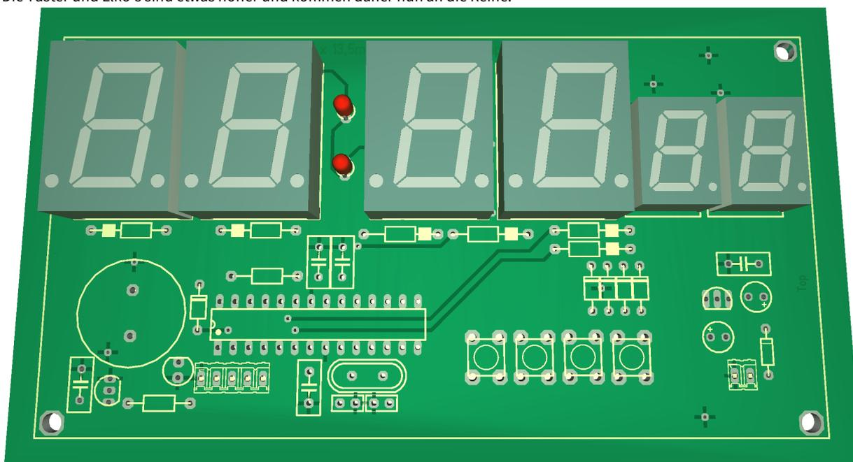
Abbildung 10: Bestückung vom SPK2201.01 Schritt 6
