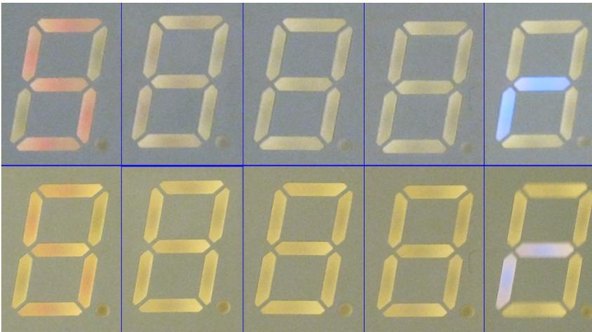
Abbildung 13: Unterschiede der Display Lesbarkeit Helligkeitsstufe 1
