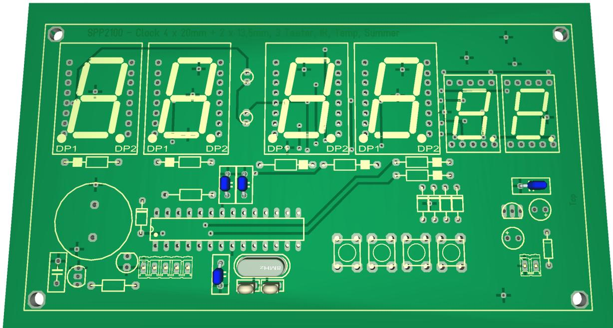
Abbildung 6: Bestückung vom SPK2201.01 Schritt 2
