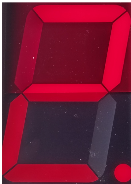
Abbildung 21: SA40-19SRWA oben rote und unten graue Kontrastscheibe mit Gegenlicht
