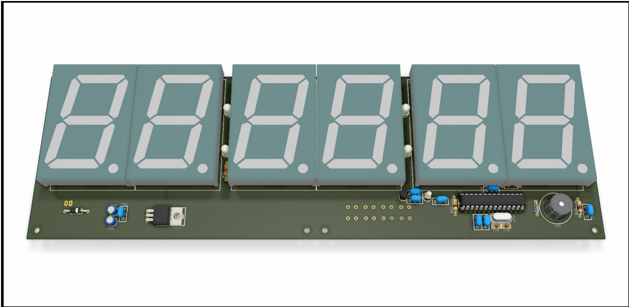
Abbildung 16: Komplette Bestückung vom SPK2141.01 mit Anzeigen Die Fertigaufgebaute Leiterplatte, es fehlen nur noch die Leitungen zur Versorgungsspannung und zum DCF Empfänger.
