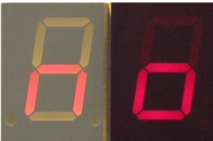
Abbildung 16: SA08-11SRWA links ohne und rechts mit Kontrastscheibe ohne Gegenlicht
