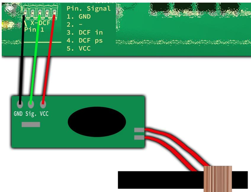
Abbildung 19: DCF Verbindung mit VCC
