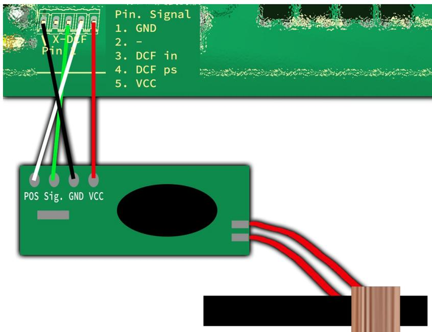
Abbildung 21: DCF Verbindung mit VCC und PowerSave
