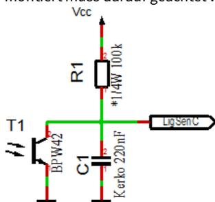
Beim BPW42 und ähnlichen Fototransistoren im LED Dioden Gehäuse muss der Lichteinfall wie folgt erfolgen, um das beste Ergebnis zu erhalten:
