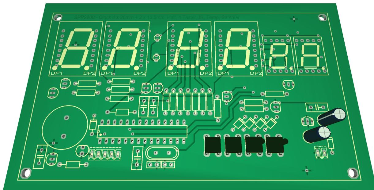
Abbildung 9: Bestückung vom SPK2121.01 Schritt 5
