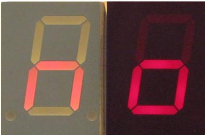
Abbildung 15: SA08-11SRWA links ohne und rechts mit Kontrastscheibe bei Gegenlicht
