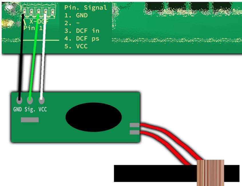
Abbildung 20: DCF Verbindung mit PowerSave
