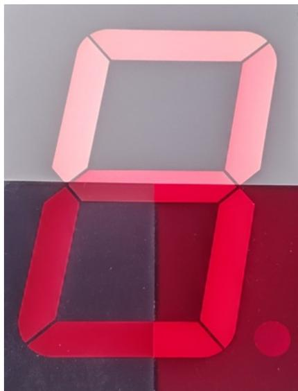
Abbildung 17: SA40-19SRWA oben ohne, unten links graue und rechts mit rote Kontrastscheibe mit Gegenlicht
