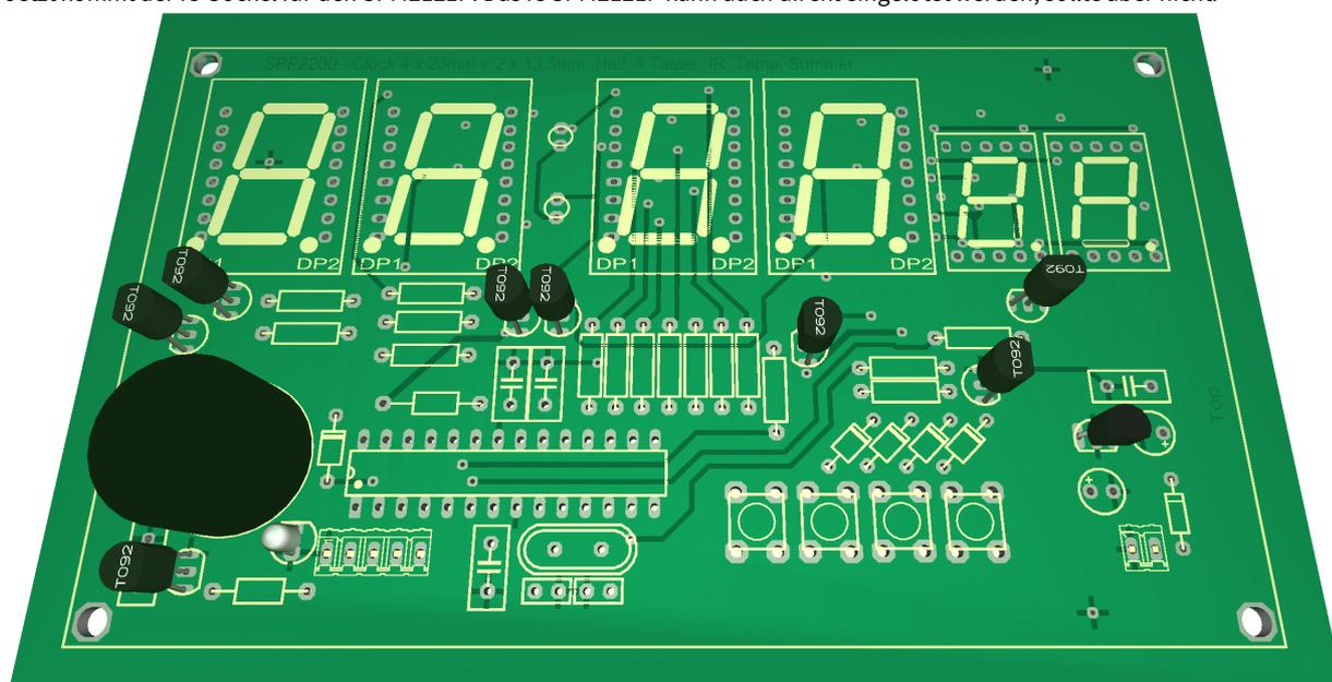
Abbildung 8: Bestückung vom SPK2121.01 Schritt 4
