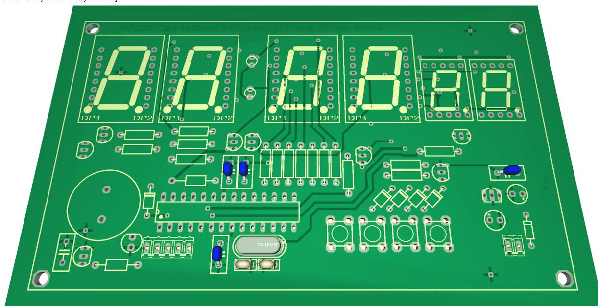
Abbildung 6: Bestückung vom SPK2121.01 Schritt 2
